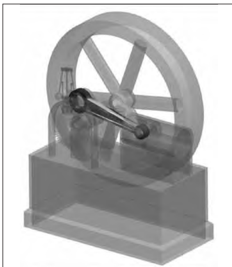
Рис. 1. Моделирование динамики гибкого тела в NX
