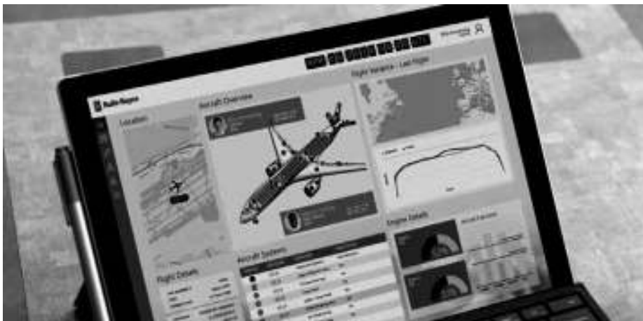
Рис. 4. PI System используется Rolls-Royce для мониторинга за состоянием двигателей
