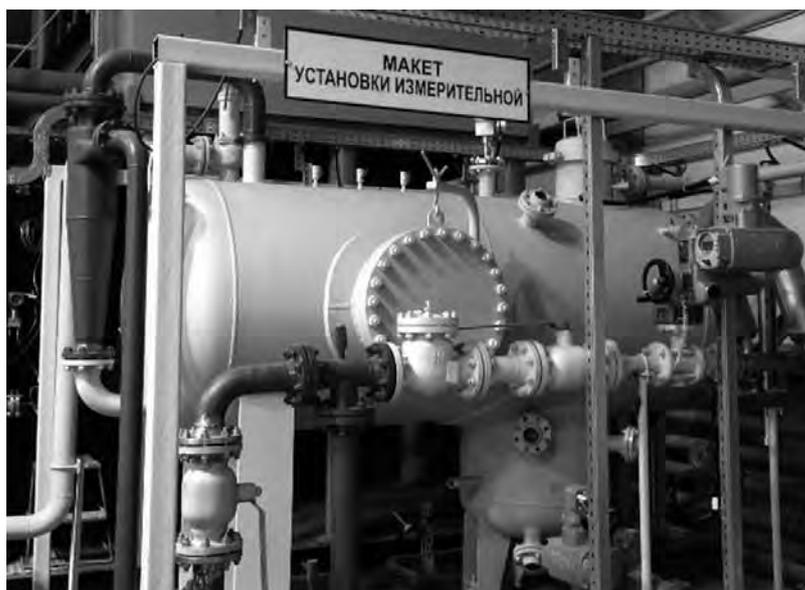
Рис. 1. Макет установки измерительной МЭРА. Производитель - АО «ГМС Нефтемаш»
