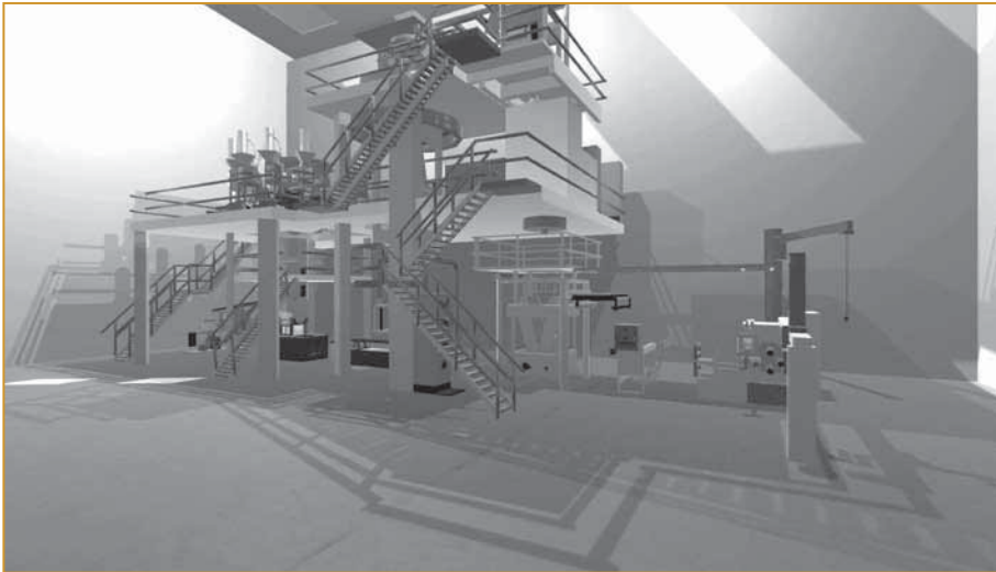
Рис. 6. Виртуальная модель экструзионной линии по производству многослойных полимерных пленок (Германия)
