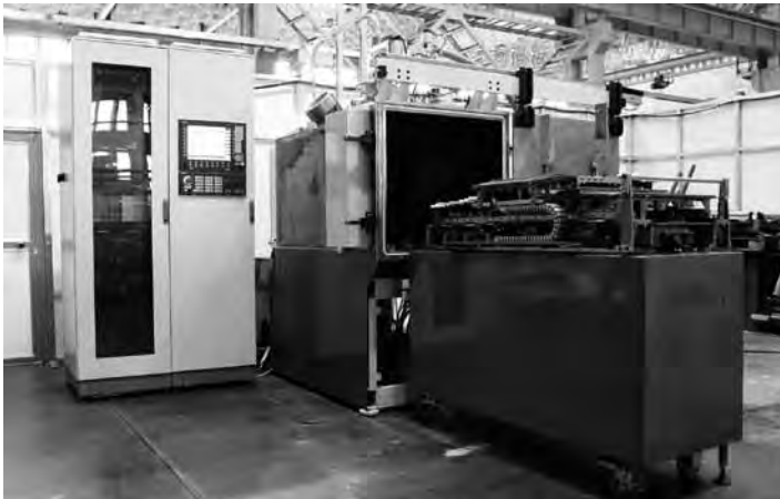
Рис. 3. Установка электронно-лучевой сварки ЭЛУ-08КП-ИРЗ
