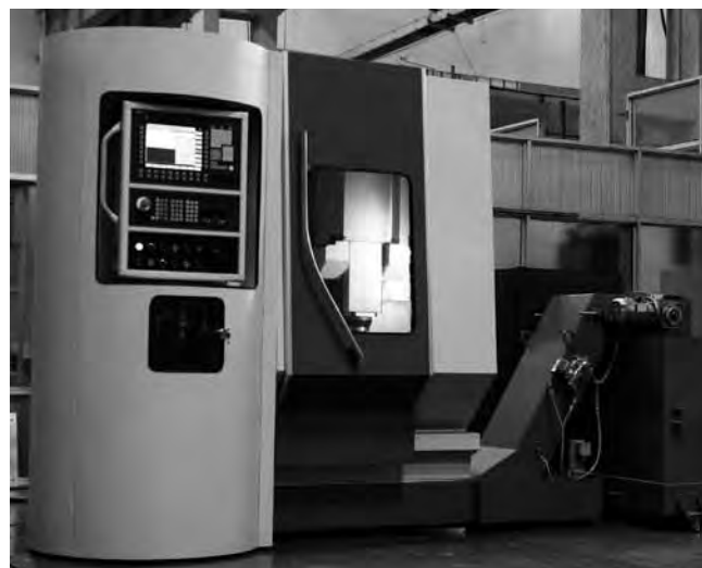
Рис. 1. Пятикоординатный обрабатывающий центр MC-300M с магазином инструментов на 24 позиции
