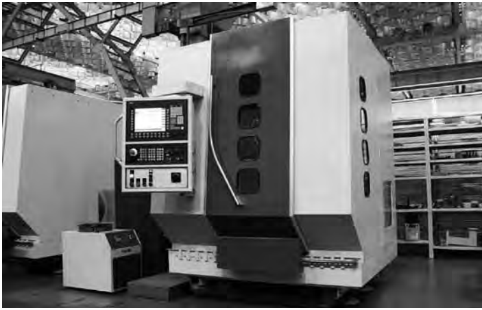
Рис. 2. Установка лазерно-плазменной обработки поверхности MC-300 «Лазер»
