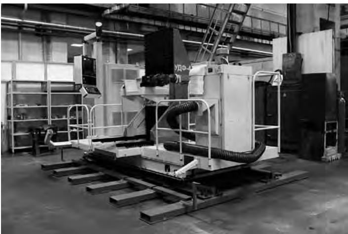
Рис. 4. Установка дробеударного формообразования УДФ-4 на сборочном участке ОАО НИАТ
