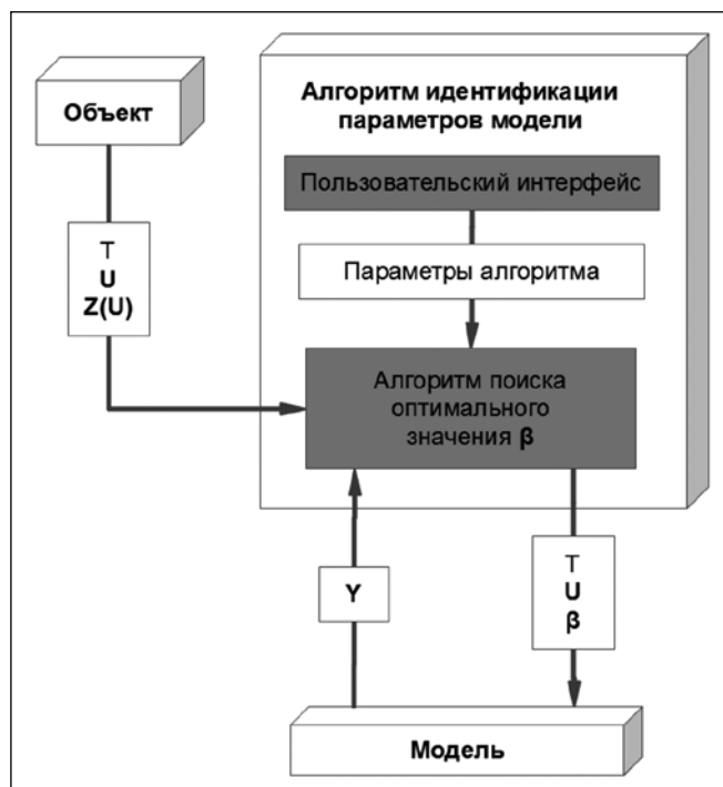
Рис. 2. Принципиальная схема метода идентификации
