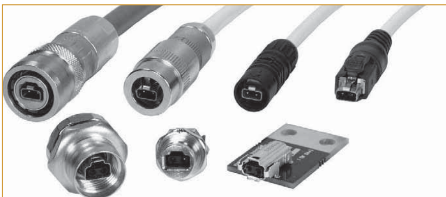
Рис. 8. Соединители для SPE, соответствующие IEC 63171-6, в вариантах исполнения IP65/67 и IP20 (верхний ряд слева направо): соединитель M12 с механизмом блокировки PushPull, соединитель M8 с механизмом блокировки PushPull, соединитель M8 с защелкой и соединитель в исполнении IP20. Нижний ряд слева направо: гнездовой соединитель M12 с винтовой фиксацией и механизмом блокировки PushPull, разъем M8 с защелкой и механизмом блокировки PushPull, угловой гнездовой компонент печатной платы в исполнении IP20
