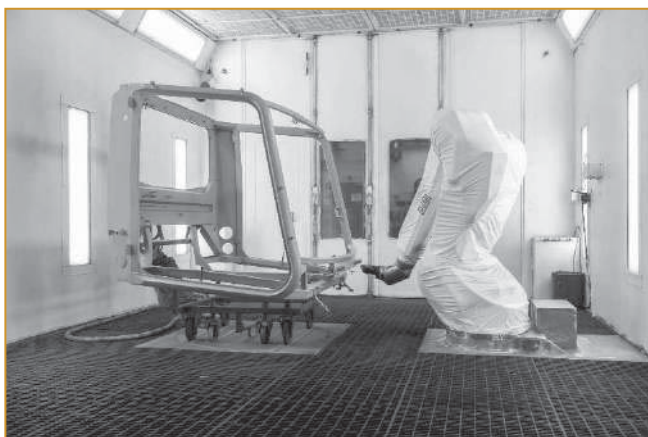
Рис. 1. Компания Kässbohrer Geländefahrzeug AG автоматизирует процесс покраски с помощью роботов EcoRP L033 концерна Dürr
