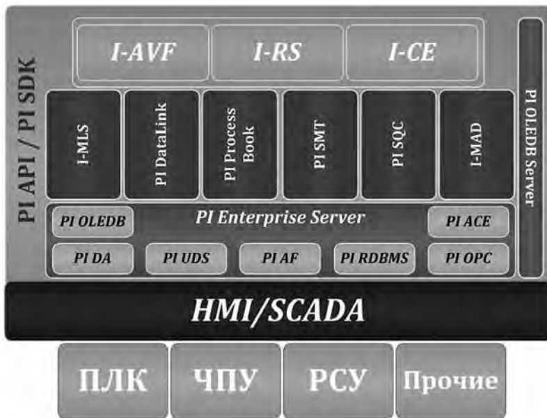
Рис. 1. Программно-технический комплекс системы диспетчерского контроля и управления Бованенковского НГКМ
