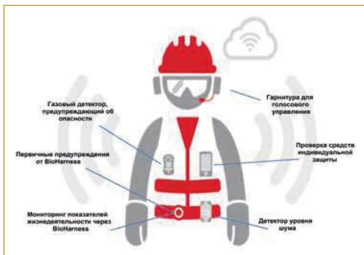
Рис. 1. Носимый комплект безопасности полевого работника от Honeywell
