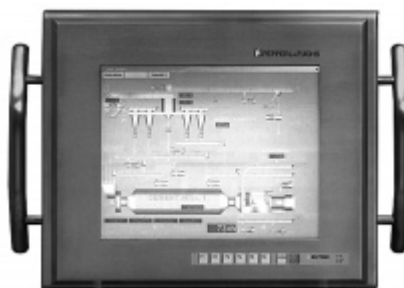
Рис. 2. Внешний вид конструкции взрывозащищенного ПК семейства VisuNet PC
