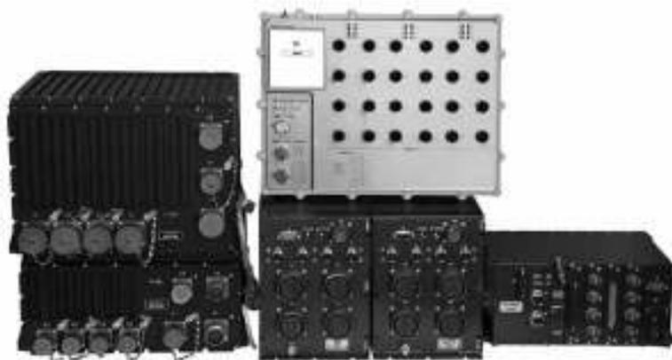
Рис. 5. Опытный образец системы диагностики планера и ответственных узлов вертолета
