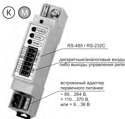
Рис. 1. ZigBee Pro модем AnCom RZ/B: крепление на DIN-рейку, диапазон температур -40...70°С
