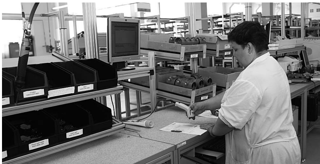
Рис. 4. Сборочная линия датчиков давления Метран-150
