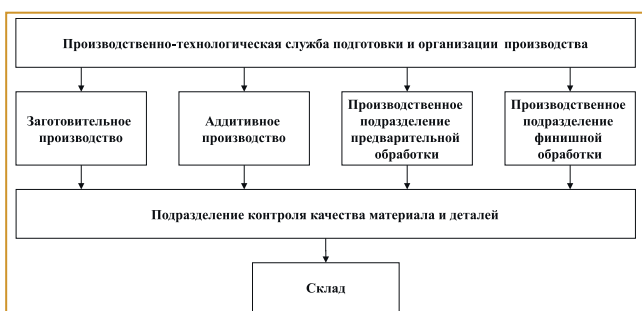
Рис. 1. Структура типовой замкнутой аддитивной гибкой производственной системы
