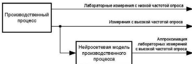
Рис. 3. Восстановление лабораторных измерений по нейросетевой модели
