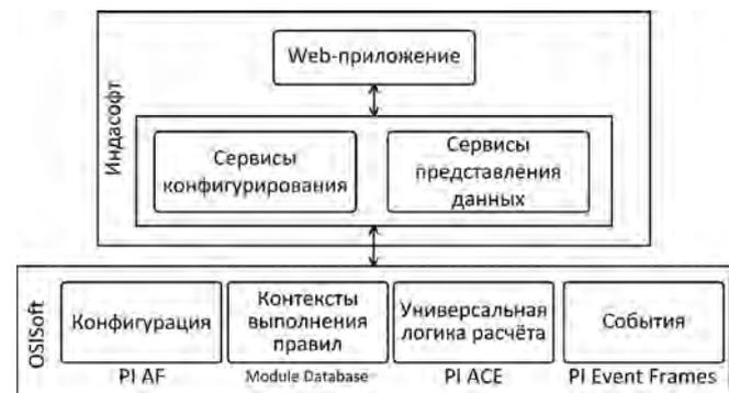
Рис. 9. Структурная схема модулей аварийного журнала
