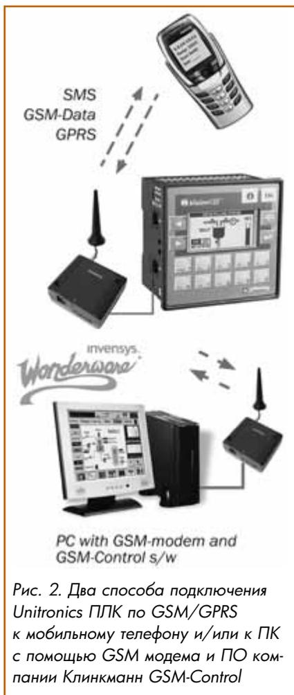
Рис. 2. Два способа подключения Unitronics ПЛК по GSM/GPRS к мобильному телефону и/или к ПК с помощью GSM модема и ПО компании Клинкманн GSM-Control
