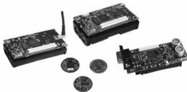
Рис. 3. Беспроводные модули ZigBee компании Crossbow Technology: 1) MICAz; 2) MICA2; 3) MICA2DOT; 4) Cricket ронного разработчика. Например, для модулей MICAz это: MTS101CA (световой сенсор, температурный плюс возможность разработки собственного прототипа), MTS300CA (свет, температура, акустический сенсор), MTS310CA (то же, что и у предыдущего, но дополнительно магнитный сенсор и сенсор ускорения).
