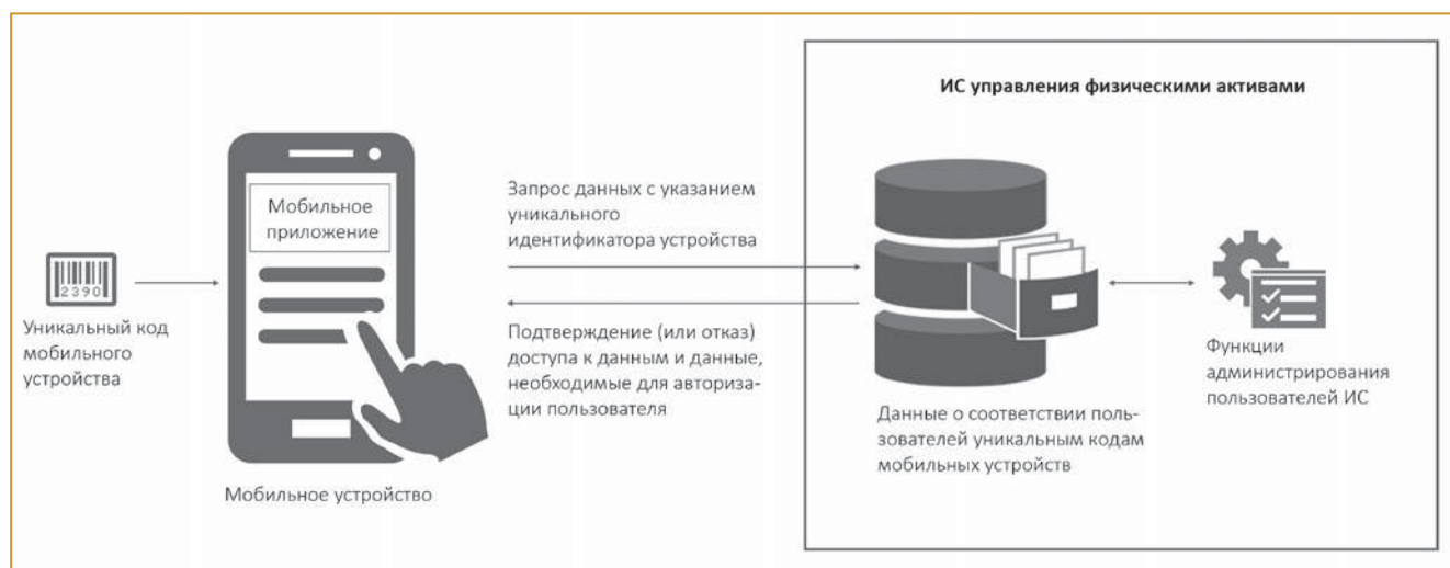
Рис. 1. Администрирование пользователей мобильных приложений с использованием уникальных идентификаторов мобильных устройств
