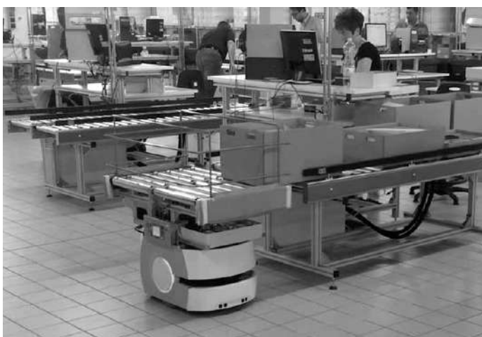
Рис. 3. Мобильный робот выпускается в конфигурациях с плоским верхом, конвейер и тележка
