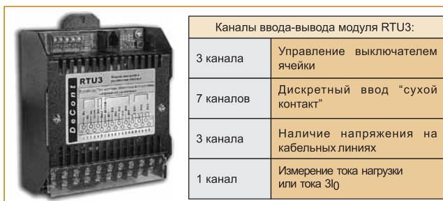
Рис. 3. Внешний вид (без защитной крышки) и основные характеристики модуля управления ячейкой.
