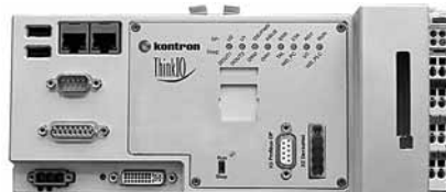
Рис. 3. Передняя панель ThinkIO Premium. Продукт рассчитан для применения на транспорте, в промышленном управляющем и коммуникационном оборудовании
