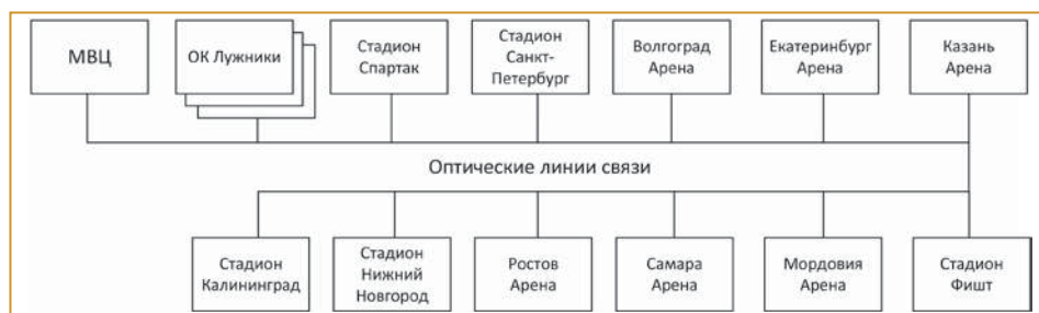
Рис. 6. Структура единой системы мониторинга и диагностики ЧМ 2018
