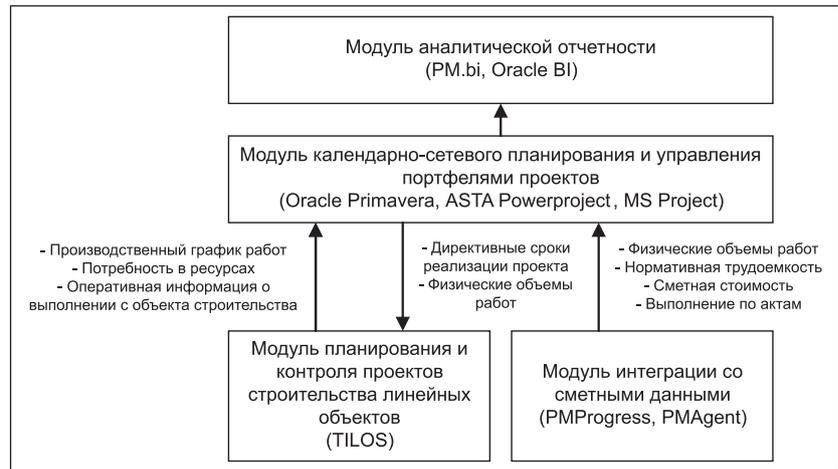
Рис. 7. Интеграция ПО TILOS в информационную систему для управления проектами
