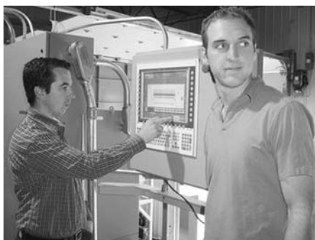
Рис. 1. Power Panel обеспечивает возможность центрального управления всей системы
