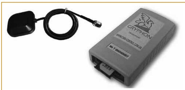
– по сигналам от спутников навигационной системы GPS NAVSTAR передавать информацию о координатах текущего местонахождения, скорости и направлении движения транспортного средства на сервер специализированного Internet-портала [www.cars-control.ru](http://www.cars-control.ru);
