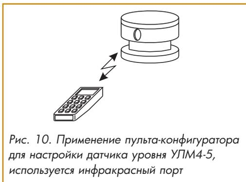
Рис. 10. Применение пульта-конфигуратора для настройки датчика уровня УЛМ4-5, используется инфракрасный порт
