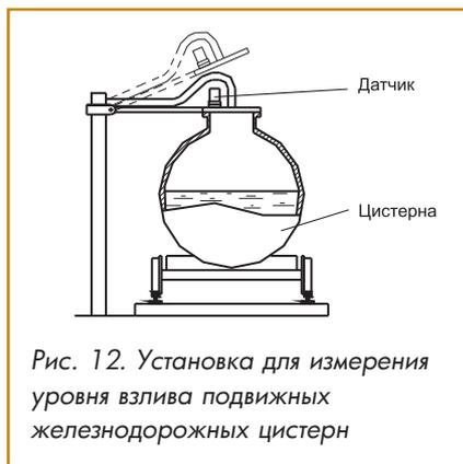
Рис. 12. Установка для измерения уровня разлива подвижных железнодорожных цистерн
