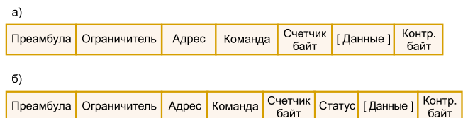
Рис. 6. Формат HART-кадра: а) Кадр "Управляющее устройство > Датчик"; б) Кадр "Датчик > Управляющее устройство"
