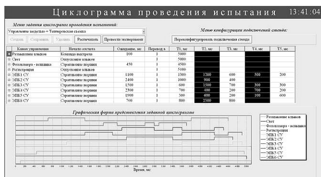
Рис. 2. Редактор циклограммных моделей конкретных испытаний
