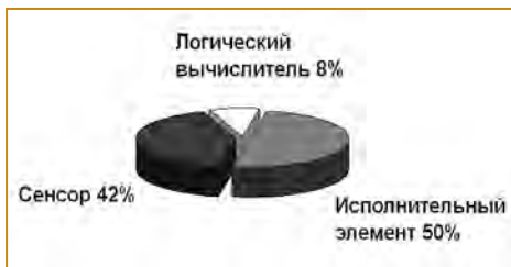
Рис. 2. Статистика отказов элементов систем ПАЗ по данным OREDA (Offshore Reliability Database)
