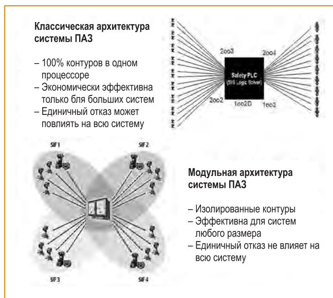
Рис. 7. Классическая и модульная архитектуры систем ПАЗ
