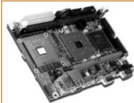
Рис. 5. Одноплатный компьютер JREx-PM производства компании Kontron Embedded Modules. Возможно, приблизительно так будет выглядеть новый промышленный стандарт для 3,5-дюймовых решений
