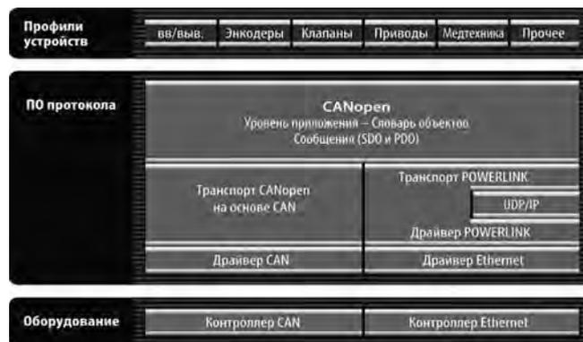
Рис. 1. Много общего: OSI-модель CANopen и POWERLINK
