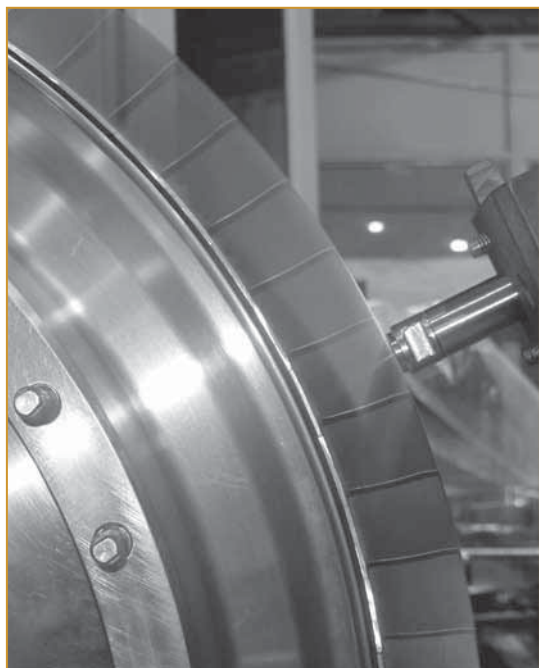
Рис. 1. Оптоволоконный датчик, установленный над лопатками рабочего колеса
