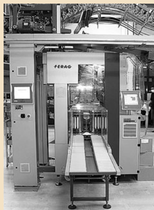
Рис. 2. Синхронизация позиционирования газеты и печати адресов управляется модульным ПК CX1020
