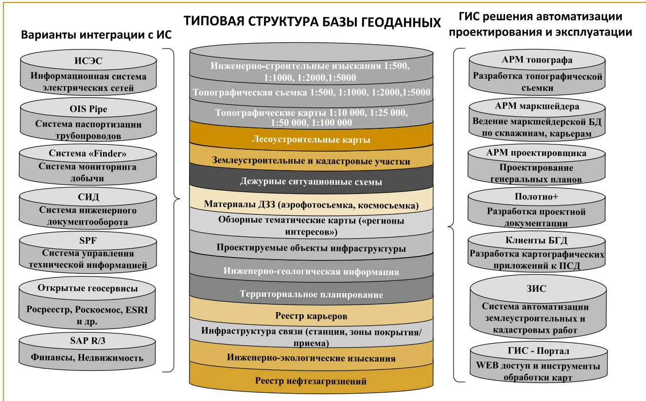
Рис. 2. Типовая структура базы геоданных ОАО «ТомскНИПИнефть»
