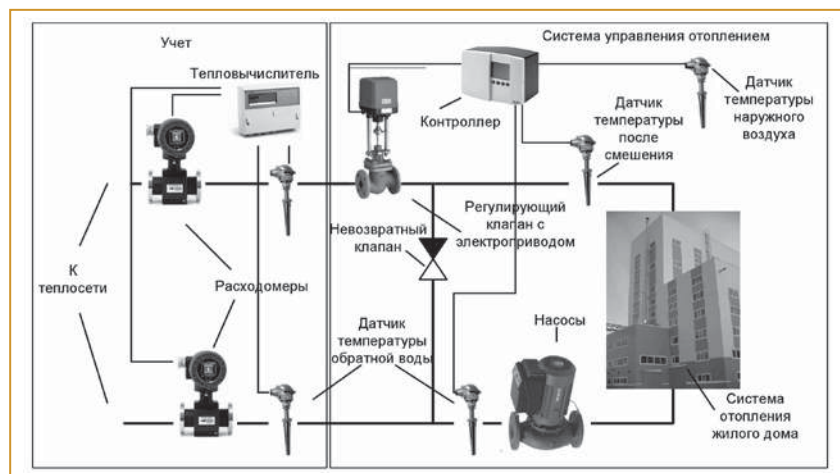
Рис.2. Схема автоматизированного теплового пункта
