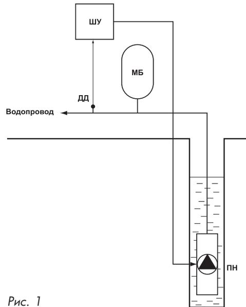
Такая классическая схема дешева, проста в монтаже и обслуживании. Однако после обследования объекта и имеющегося оборудования выяснилось следующее:
