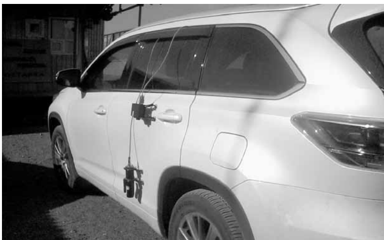
Оптический датчик ИСД 3 и лазерный ИСД 5, закрепленные на автомобиле во время тестовых заездов
