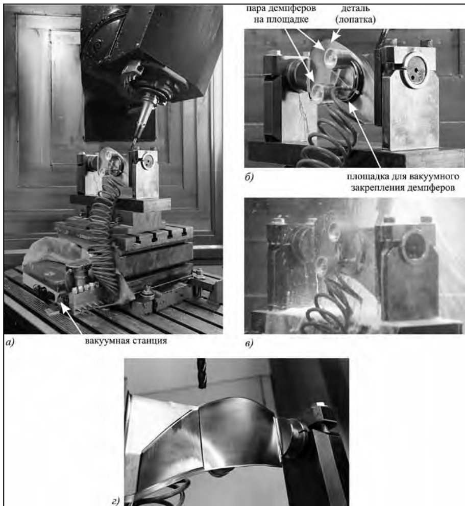
Рис. 3. Изготовление лопаток аэродинамической модели компрессора с использованием технологических демпферов: а) общий вид детали в приспособлении; б) пара демпферов, закрепленная на детали с помощью общей вакуумной присоски; в) получаемая высокая чистота обработанной поверхности
