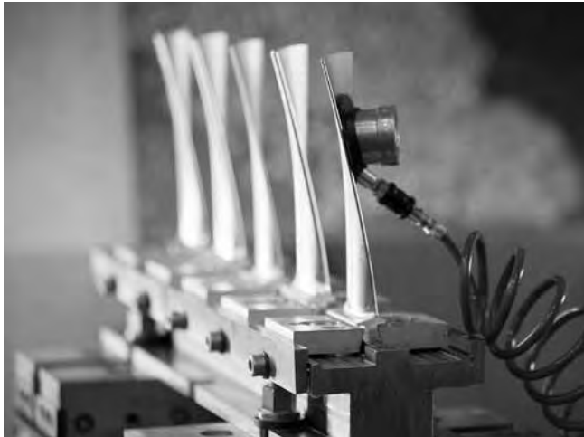
Рис. 4. Обработка турбинных лопаток с консольным закреплением только за замок и использованием демпфера
