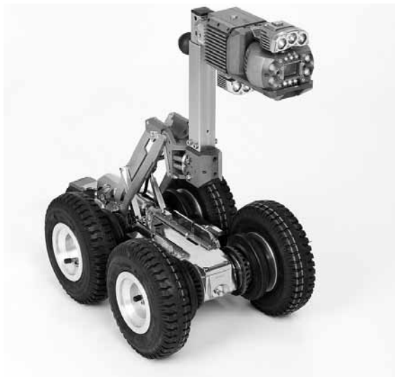
Рис. 1. Самоходный робот-тележка с видеокамерой для теледиагностики трубопроводов
