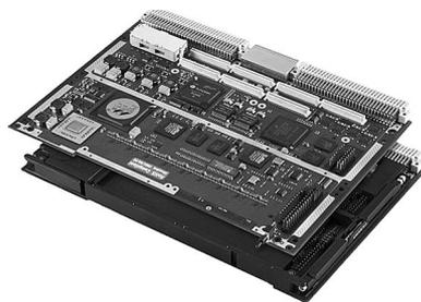
Рис. 1. "Устойчивая к радиации" COTS-плата GE Fanuc EP2A
