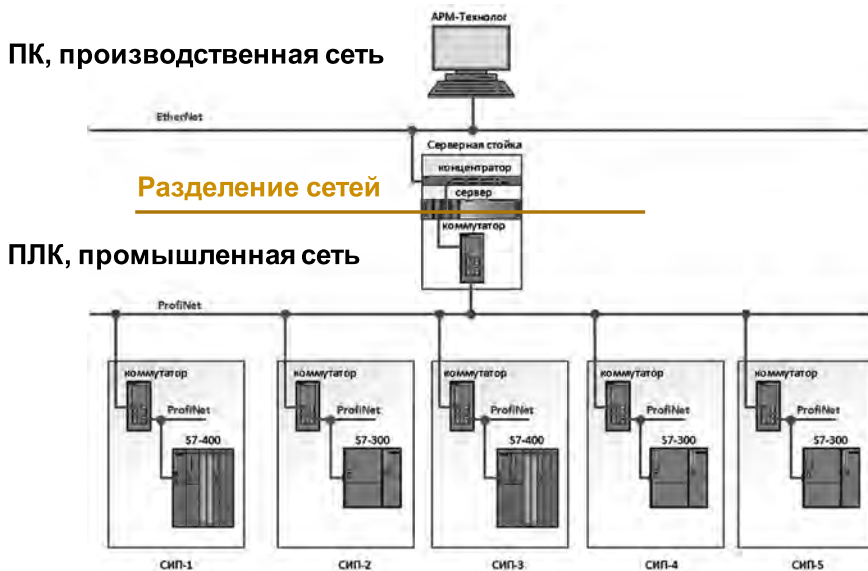
Рис. 2. Структурная схема АСУТП мойки оборудования
