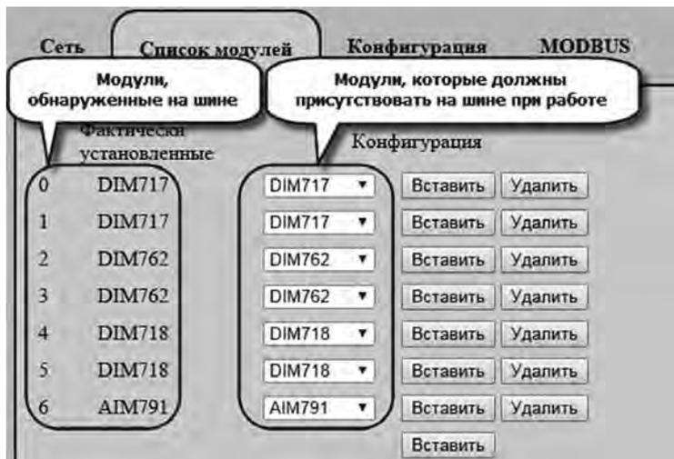
Рис. 3. Вкладка создания списка модулей ввода/вывода NIM745-02
