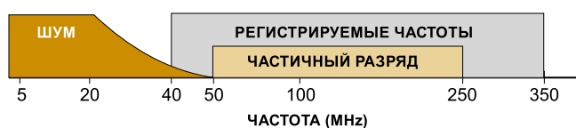
Рис. 4. Порядок выделения импульсов ЧР
