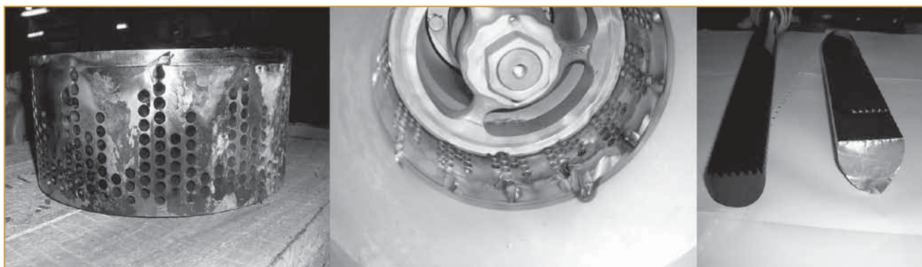
Рис. 2. Выход из строя механической части клапана
