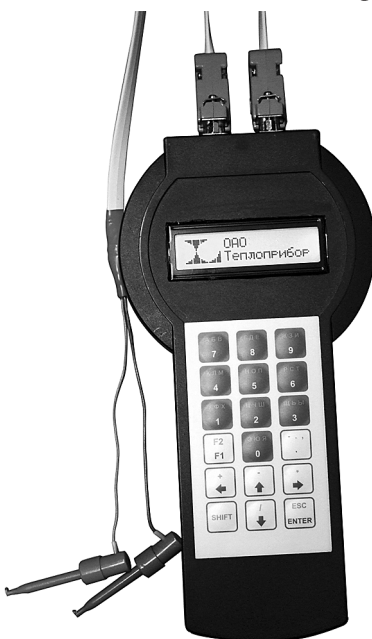
Рис. 1. Унифицированный коммуникатор дистанционной связи
