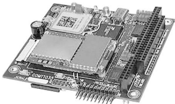
Часто к промышленным объектам затруднена или невозможна прокладка кабеля. В этом случае проблему могут решить GSM и GPRS модемы, которые устойчиво работают в жестких условиях эксплуатации при наличии сильных электромагнитных помех.
