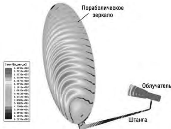
Рис. 1. Зеркальная параболическая антенна, облучаемая рупором, с рассчитанными на них токами, текущими на поверхности
