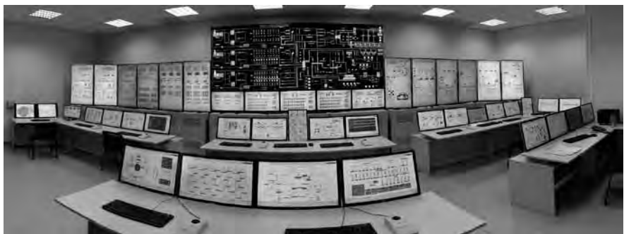
Рис. 1. Аналитический тренажер реактора БН-800
